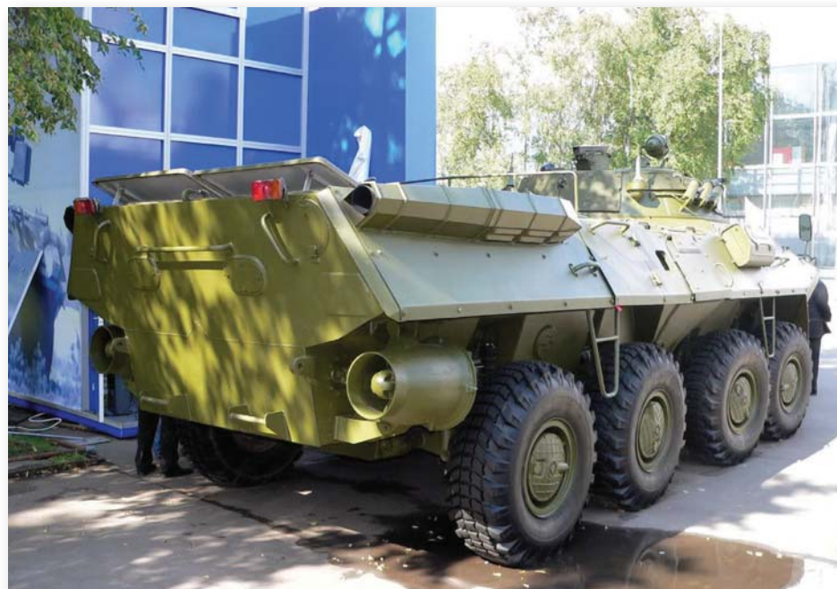
Задња страна са видљивим водомлазним покретачима
