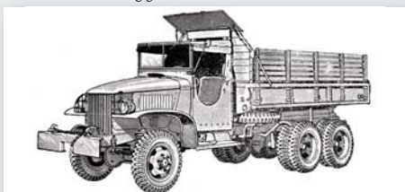
Модел CCKW-353 X1/2 (са чекрком) са ошвореном кабином, модел 1619, и сандуком самоизвршачем
