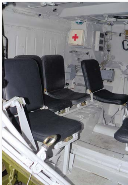
Седишта за војнике наслонена су на задњу преграду, која их дели од моторног одељења
