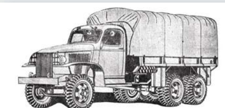
Камион GMC, 2½ t, 6x4 модел CCKW-353 са затвореном кабином модела 1608 и обичним сандуком
